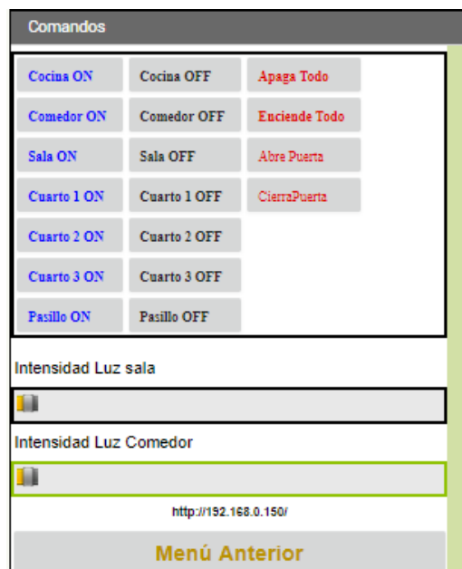
Figura 3. Pantalla de comandos de la Aplicación Smart House ITSVR (PANTOJA, 2018)
