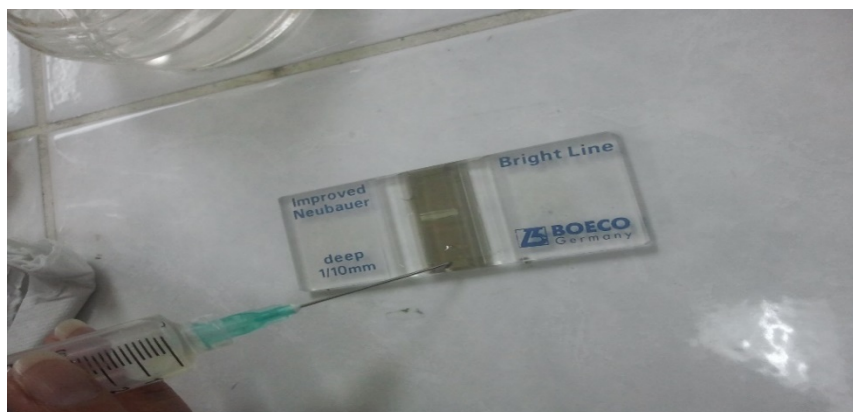
Figura 1. Cámara de Neubauer para conteo de esporas
